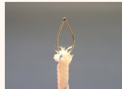
④加工は瞬間的に完了します。クロスに溶接した先端の余分な部分をカットします。
