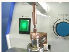
電極先端にタングステンのピンが埋め込まれた電極で、
