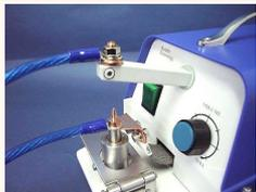
コードで電極を装置外部に取り出し、スペースフリーで自由度の高い作業が行えます。溶接案件によっては作業性能を拡張、向上することが出来ます。溶接案件の形状・材質に合わせて選択できる数種類の電極を標準化しています。
