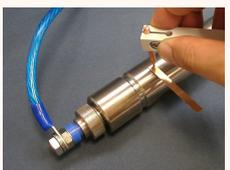
自由度が高く、作業が容易な小手電極とマグネット付の電極との組合せです。磁性材料の被溶接ワークに薄板・細線を溶接するとき使用します。マグネットで電極を取付けますのでワークの形状や大きさに制限はありません。(マグネット電極を取付けるための一部平らな箇所は必要です。)もう一方の小手電極で溶接する細線・薄板をワークに押し当てて溶接します。
