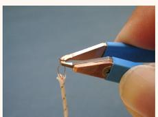
電極の片側にモリブデンチップ電極(タングステン電極と同様の効果)を取付けてあるピンセットタイプの電極です。銅の細線や箔の溶接をピンセットタイプの電極で作業したいときに使用します。
