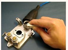
自由度が高く、作業が容易な小手電極とクリップタイプ電極の組合せです。シャフトや出っ張りのある被溶接ワークに薄板・細線を溶接するとき使用します。クリップ電極でワークを掴んでおき、小手電極で溶接する薄板・細線をワークに押し当てて溶接します。
