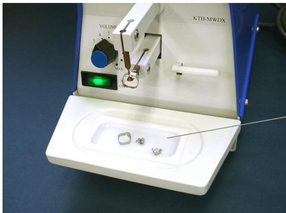
トレーを装着して作業。トレーは皿状で材料の置き場所として利用できます。
