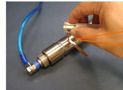
もう一方の被溶接材料を重ね、その上から小手電極を垂直に押し当ててセットする。
