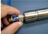
被溶接材料の平らな箇所に電極(銅色の中心軸)をあてる。
