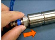
ノブを材料側へ押し下げ固定する。
